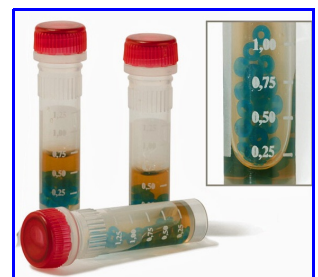
Abb. 1. Cryoröhrchen mit Glasperlen und Hefe-Cryomedium.
