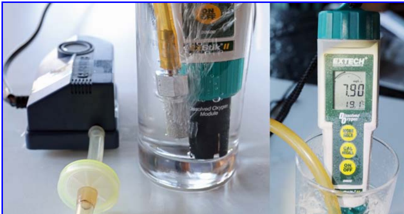
A4. Messung Gesamtsauerstoff. belüftetes Trinkwasser, T = 19.1\text{ °C} , DO = 7.90\text{ mg O}_2/\text{L} .
