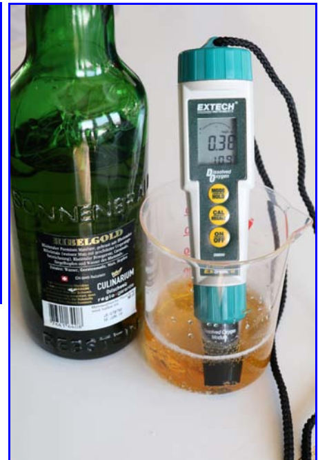
A5. Messung Gesamtsauerstoff. Maisbier Ribelgold , Brauerei Sonnenbräu . T = 10.9 , DO = 0.38\text{ mg O}_2/\text{L} (gekauft am 25.11.2018, Haltbarkeitsdatum 14.06.2019 \rightarrow geschätztes Alter ca. 4 Monate, Bügelflasche \rightarrow Diffusion mind. 0.2-0.3 ppm).
