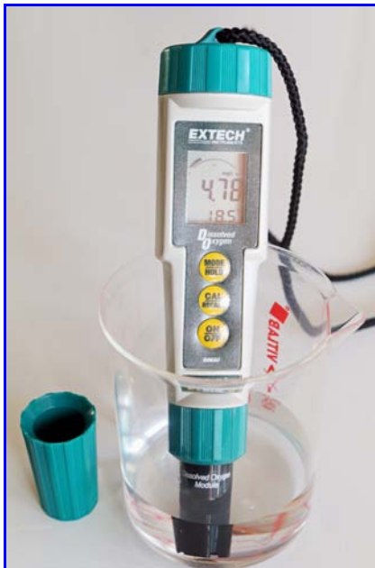
A1. Messung Gelöstsauerstoff. frisches Leitungswasser, T = 18.5\text{ °C} , DO = 4.78\text{ mg O}_2/\text{L} .
