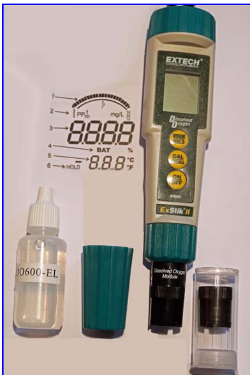
Abb. 5. Messgerät DO600 inkl. Zubehör.
