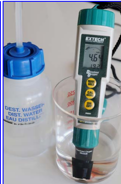
A2. Messung Gelöstsauerstoff. gestandenes dest. Wasser, T = 19.2\text{ °C} , DO = 4.64\text{ mg O}_2/\text{L} .
