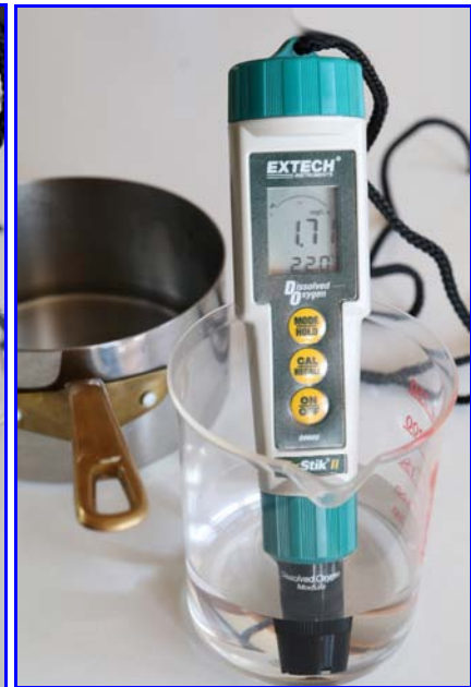
A3. Messung Gelöstsauerstoff. abgekochtes Trinkwasser, T = 22.0\text{ °C} , DO = 1.71\text{ mg O}_2/\text{L} .
