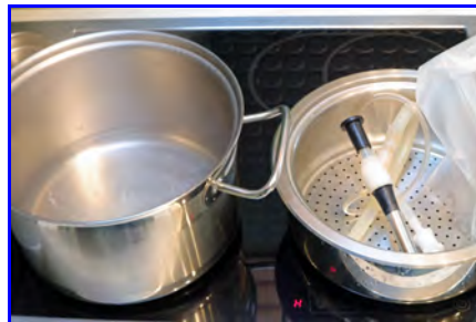
Abb. 2. Erhitzen im strömendem Wasserdampf. Oben: Kochtopf mit Wasser und mit Dampfeinsatz aus Edelstahl. Geeignet z.B. für Oberflächenentkeimung, Kunststoffobjekte. Bsp. hier: Abfüllpistole.
