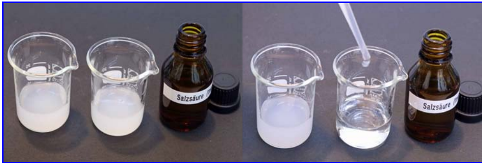
Abb. 5. Kalktest mit Salzsäure. Links: zwei identische \text{CO}_2 -Nachweisproben mit dem typisch milchig-weisslichen Kalkniederschlag. Rechts: Salzsäure HCl löst den Kalk auf.
