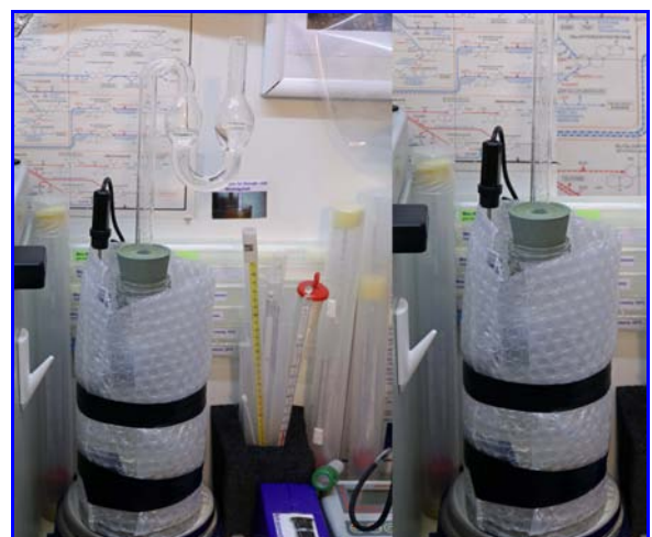
Abb. 8. Gäransätze isoliert und auf Magnetrührer. Zur schnelleren Gärung können die Gärgefässe auch mit Verpackungsmaterial isoliert und sanft gerührt werden.
