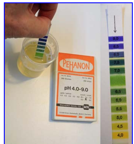
Abb. 7. pH-Bestimmung mit pH-Indikator-teststreifen mit aufgedruckter pH-Skala.
