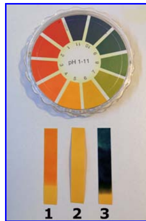
Abb. 2. Universalindikatorpapier, pH 1-11, Abstufung 1 pH-Einheit. 1: pH 4 (schwach sauer), 2: pH 7 (neutral), 3: pH 11 (stark basisch).
