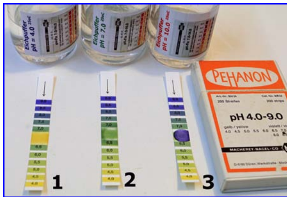
Abb. 5. pH-Indikatorteststreifen pH 4.0-9.0. Abstufung 0.5 pH-Einheiten. 1: pH 4.0, 2: pH 7.0, 3: pH 10.0. Das Testfeld in der Mitte wird mit der aufgedruckten Farbskala verglichen. Beim Teststreifen 3 wurde ein Eichpuffer von pH 10.0 aufgetropft -> Farbe Blau im Testfeld bedeutet: pH \geq 9.0.
