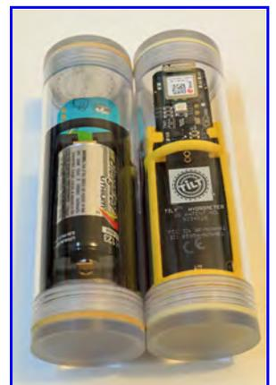
Abb. 17. TILT-Hydrometer. Schwarze Ausführung: von hinten mit Batterie; Gelbe Ausführung: von vorne.
