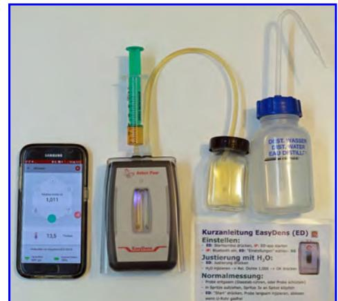
Abb. 20. EasyDens-Dichtemessgerät mit Zubehör: Smartphone, Injektionsspritze, Auffangbehälter, ention. Wasser. Messanzeige auf SG (1.011 - Endpunkt einer Hauptgärung).
