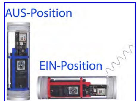
Abb. 19. EIN-/AUS-Aktivierung. Der Tilt-Hydrometer ist in stehender Position ausgeschaltet (!), in schräger bis liegender Lager aktiviert.
