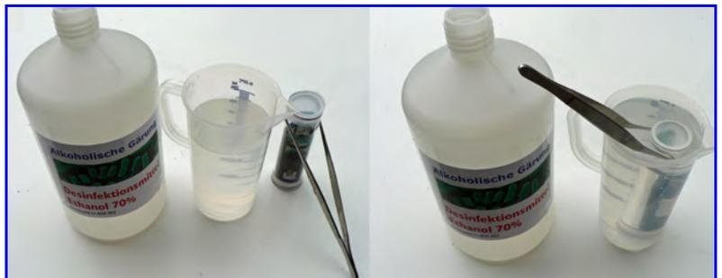
Abb.18. Entkeimung des Tilt-Hydrometers.
