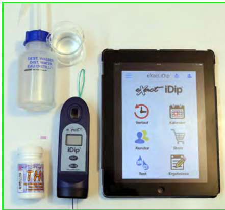
Abb. 7.1. iDip-Messsystem. 1. iDip-Fotometer, 2. iPad (Smartphone, Tablets - Android oder Apple), 3. Teststäbchen (z.B. THH für Wasserhärte), 4. Wasser: dest./ention. Wasser für Reinigungszwecke, Brauwasser im Becherglas für die Untersuchung).
