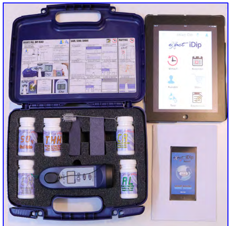
Abb. 2. Start-Grundkoffer eXact iDip für Brauwasseranalysen. Zusätzlich wird ein Smartphone oder Tablett benötigt (oben rechts).
