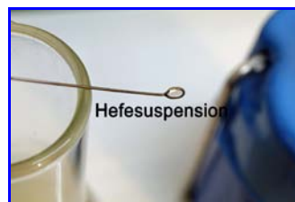
Abb. 4. Impföse muss mit Hefesuspension sichtbar gefüllt sein.
