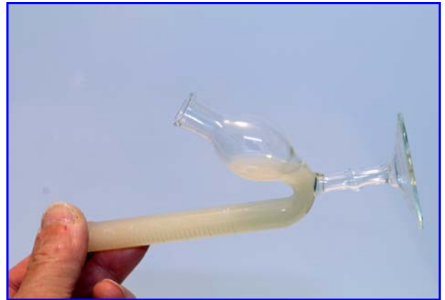
Abb. 14. Einfüllen der Hefe-Zuckerlösung in das Gähröhrchen nach Einhorn.
