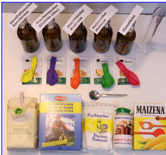
Abb. 4. Versuchsansätze zur Vergärbarkeit von verschiedenen Zuckerarten Materialien: pro Zuckerart 1 Bierflasche und 1 Luftballon, (nicht abgebildet: Kontrollansatz Hefe ohne Zucker, Kälteansatz) 1 Trockenhefebeutel pro Versuchsansatz, 5 Zuckerarten: Saccharose, Glukose, Fruktose, Maltose, Stärke.
