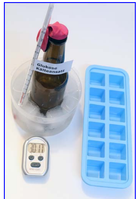
Abb. 9. Hefegärung, Kälteansatz (Eiswasser). Nach 30 min: keine Anzeichen einer CO 2 -Bildung.
