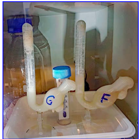
Abb. 17. Fast am Ende des Gärversuches mit Glukose [G] und Fruktose [F] nach 28 min bei 30 °C bei fast identischen CO 2 -Volumina (G: 8.3 mL, F 6.9 mL)
