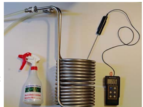
Abb. 5. Das Kühlsystem. Desinfektionsmittel (65% Isopropanol), Kühlschlange, Digitalthermometer.
