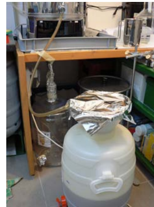
Abb. 7. Würzetransfer. Ablassen der abgekühlten Anstellwürze über ein Milchsieb in den Gärbehälter.
