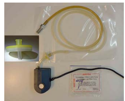
Abb. 8. Belüftungseinheit aus Aquariumpumpe, 0.2 µm Sterilfilter und Edelstahl-Würzebelüftungsstein.
