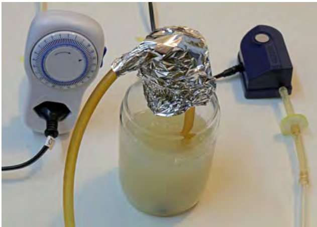
Abb. 4. Belüftung Stufe 4: aktives Belüften mit Pumpe.
