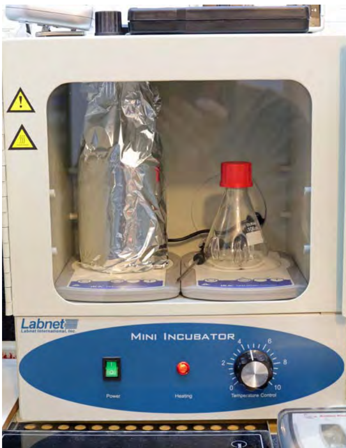
Abb. 8. Temperatur Stufe 5: Anzucht im temperatur-regulierten Mini-brutschrank. Das lichtgeschützte Anzuchtgefäß steht in einem kontrollierten Temperaturraum und zudem auf einer Magnetrührplatte → bessere Durchmischung, auch mit Luftsauerstoff → schnelleres Wachstum.
