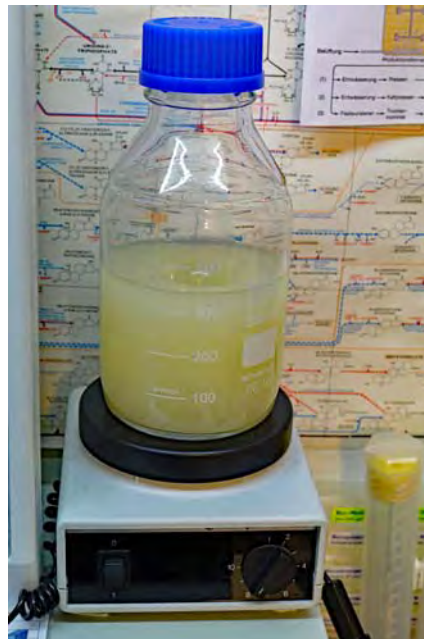
Abb. 2. Belüftung Stufe 3: auf Magnetrührer rühren.
