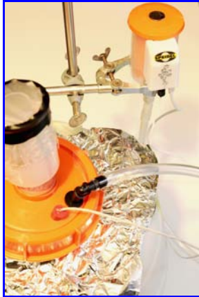
Abb. 5. Temperaturmessung im Gärbehälter.
