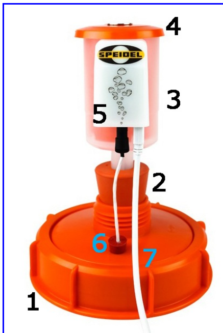
Abb. 15. GÄRSPUNDMobil von Speidel zur kontinuierlichen Registrierung der Temperatur und der CO 2 -Blops pro Zeiteinheit als Mass der Gärintensität.
