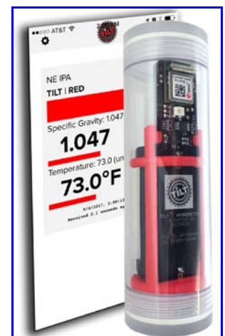
Abb. 12. Elektronisches Hydrometer zur kontinuierlichen Messung des Extraktgehaltes als SG (specific gravity) und Temperatur (°F/°C) aus dem Gärbehälter.
