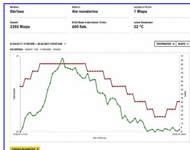
Abb. 16. Gär- und Temperaturkurven des GÄRSPUNDMobil: ----- Temperatur ----- Blops
