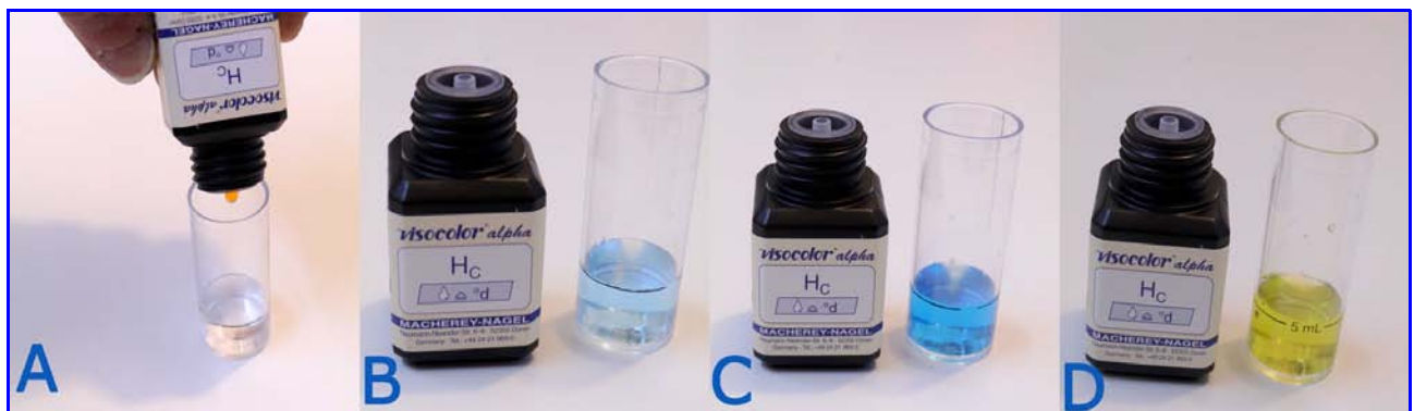
Abb. 9. Der Testablauf zur Bestimmung der Karbonathärte mit dem MN visocolor alpha-Testbesteck.
